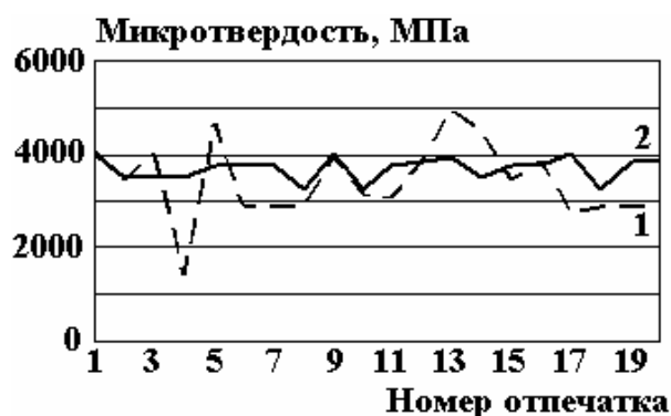
Рис. 7. Значения микротвердости кольца № 7 в исходном состоянии и после циклов ВЧМИО
