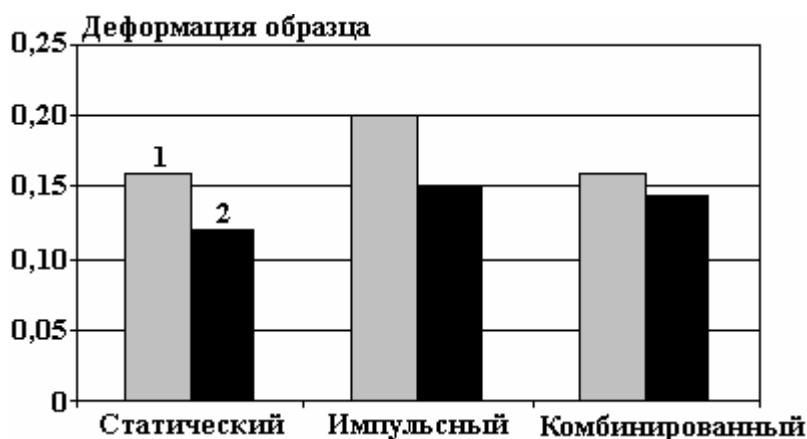
Рис. 5. Средние и максимальные деформации образцов в направлении прокатки исходных листов в зависимости от способа нагружения. 1 – максимальная деформация; 2 – средняя деформация
