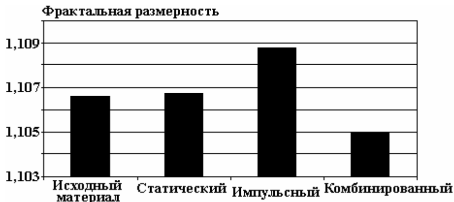
Рис. 10. Зависимость фрактальной размерности зёрен сплава 6111 от способа нагружения
