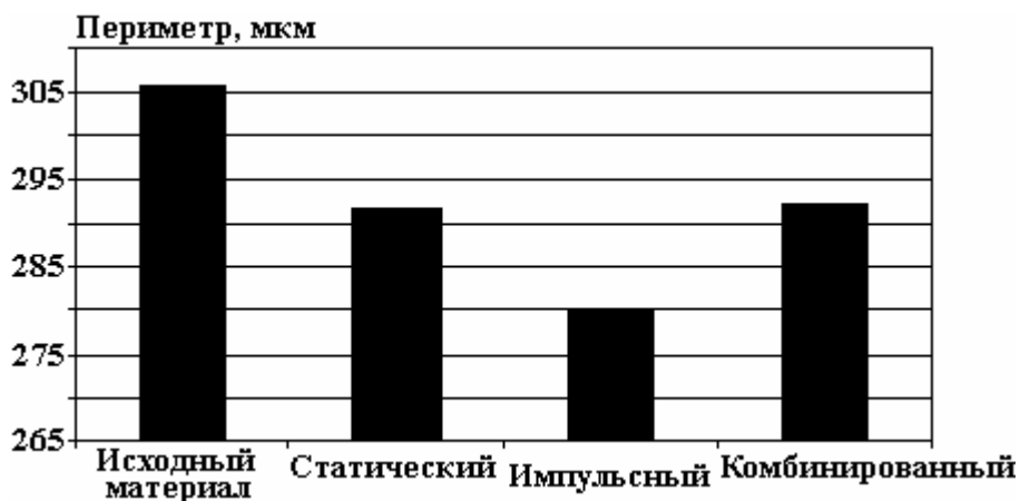
Рис. 8. Зависимость периметра зёрен сплава 6111 от способа нагружения
