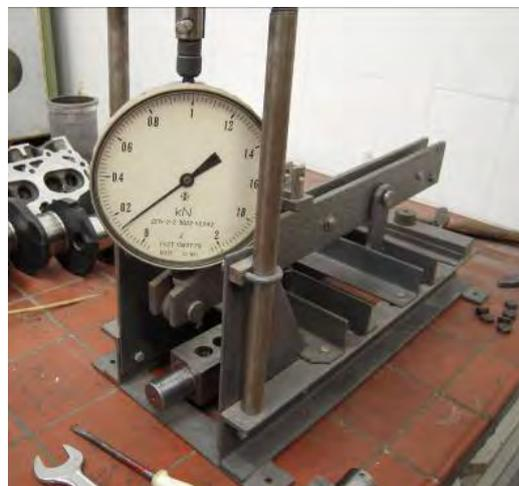
Рис. 2. Установка для испытаний на отрыв покрытий
