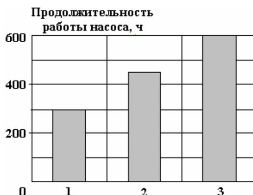
Рис. 5. Результаты производственных испытаний покрытий, полученных при условиях электролиза: 1 – в обычном режиме,  $i_k = 5,5 \text{ кА/м}^2$ ; 2 – с ИЕУ,  $i_k = 5,5 \text{ кА/м}^2$ ; 3 – то же,  $i_k = 8,5 \text{ кА/м}^2$
