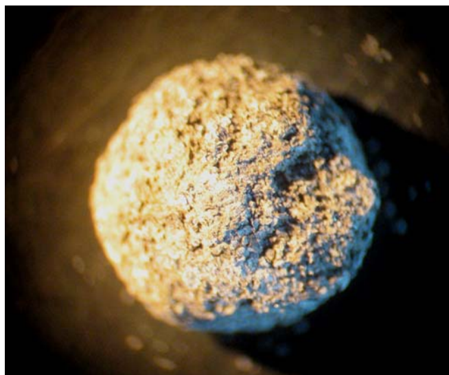
Рис. 1. Общий вид слитка состава Al(95): GaInSn(3:1:1) при 7-кратном увеличении
