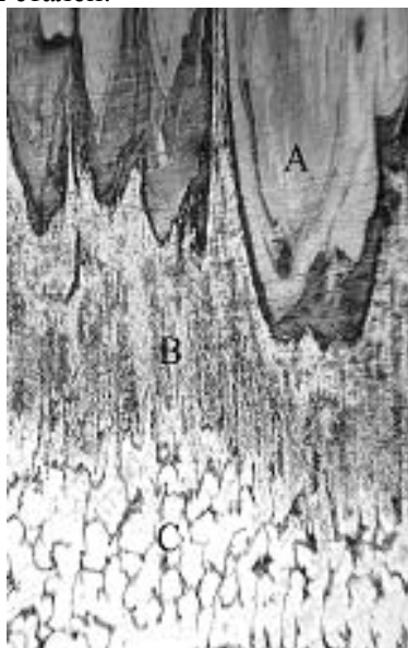
Рис. 5. Структура контактной зоны трения стали 120X15 после работы в индустриальном масле II 20А. Косой шлиф x250
