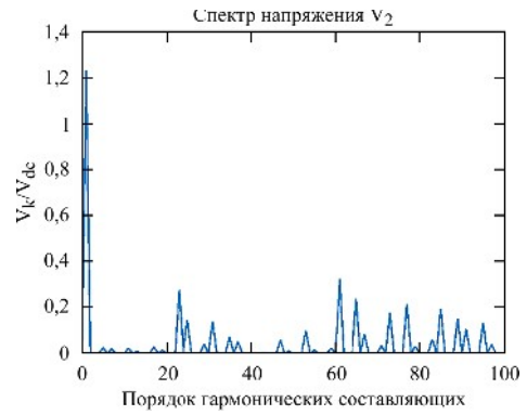
Рис. 26. Гармонический состав напряжения V_2 (ПСШИМ, m = 0,550 , F_s = 950 Гц).
