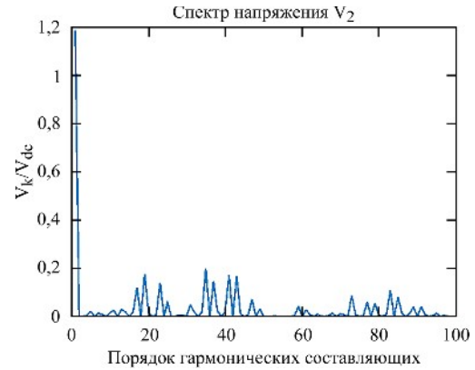
Рис. 24. Гармонический состав напряжения V_2 (НСШИМ, m = 0,550 , F_s = 950 Гц).
