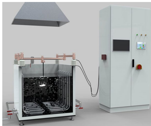
Рис. 1. Установка ПЭО МГТУ «СТАНКИН».
