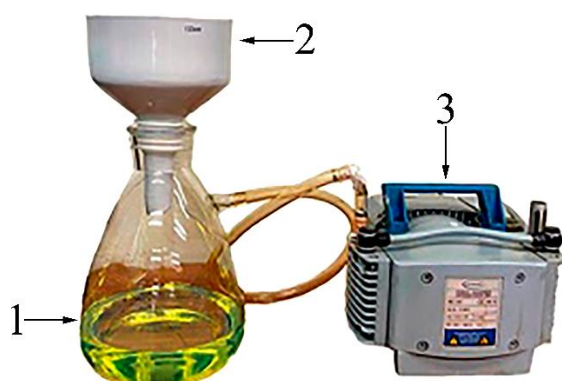
Рис. 1. Схематическое изображение установки фильтрации масла (1 – колба Бунзена; 2 – воронка Бюхнера; 3 – вакуумный насос Vacuumbrand MZ 2 NT).
