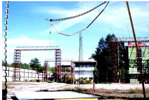
Рис. 5. Общий вид высоковольтной воздушной ДЭРС «острие–плоскость» ( l_{min} = 3,0 м) с передвижным высоковольтным омическим делителем напряжения типа ОДН-2,5, подсоединенным к ее потенциальному верхнему круглому стальному электроду–острию ( r_0 \approx 15 мм; r_c \approx 3 мм), размещенному по центру заземленного нижнего электрода–плоскости квадратной формы размером 5 \times 5 м из листовой оцинкованной стали исследуемой ДЭРС [18].
