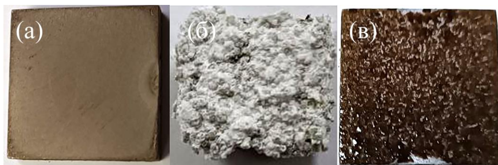
Рис. 1. Типичный внешний вид покрытий, образованных на поверхности сплава ВНМ-1 в различных электролитах при плотности тока 20 \text{ A/дм}^2 : (а) электролиты Э1–Э4; Э8, Э9; (б) электролиты Э5–Э7; (в) электролиты Э10 и Э11.
