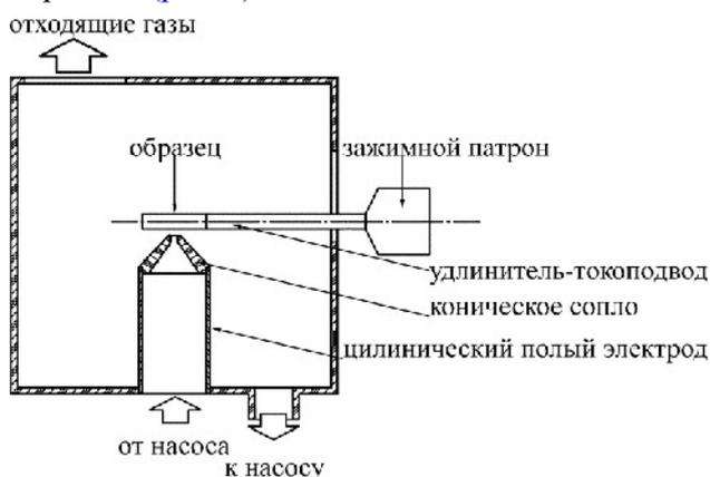
Рис. 1. Схема установки для локальной обработки.
