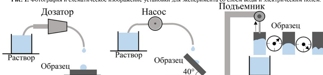
Рис. 2. Иллюстрации к измерению количественных параметров изменения гидрофобности: измерение статического контактного угла смачивания с помощью метода сидячей капли (а); измерение скорости стекающих капель с наклонного образца (б); измерение стягивания водной пленки с вертикально расположенного образца (в).
