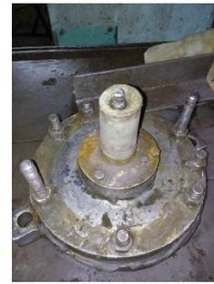
Рис. 5. Высоковольтный электрод на рабочем столе пресса T1226Б.
