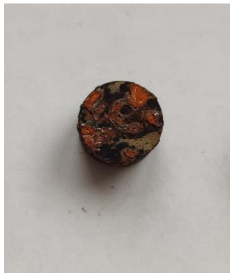
Рис. 1. Изменение массы подложки из стали Ст3 в процессе выдержки в солевой камере (а) и ее изображение (б).
