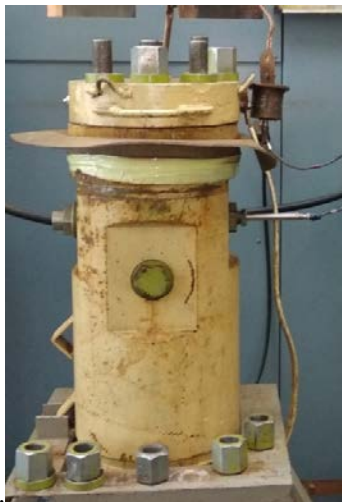
Рис. 2. Разрядная камера с ограниченным объемом жидкости.
