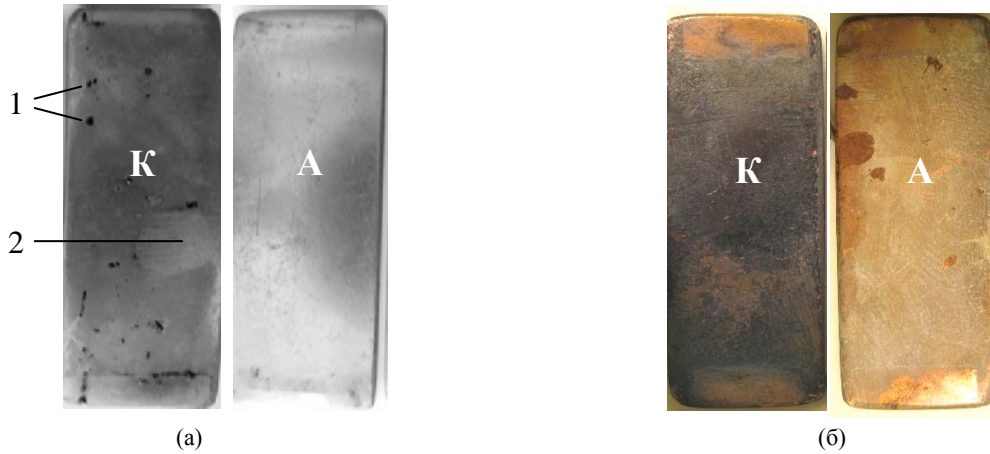
Рис. 7. Поверхности электродов после выдержки в растворе ТМ+I при напряженности 20 кВ/см в течение суток; А – анод; К – катод; 1 – пятна кристаллического йода; 2 – участок, очищенный от адсорбированного йода; (а) – Ti электроды; (б) – Cu электроды [29].
