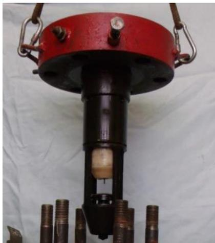
**Рис. 5.** Внешний вид электродной системы, которая использовалась в экспериментальных исследованиях.
