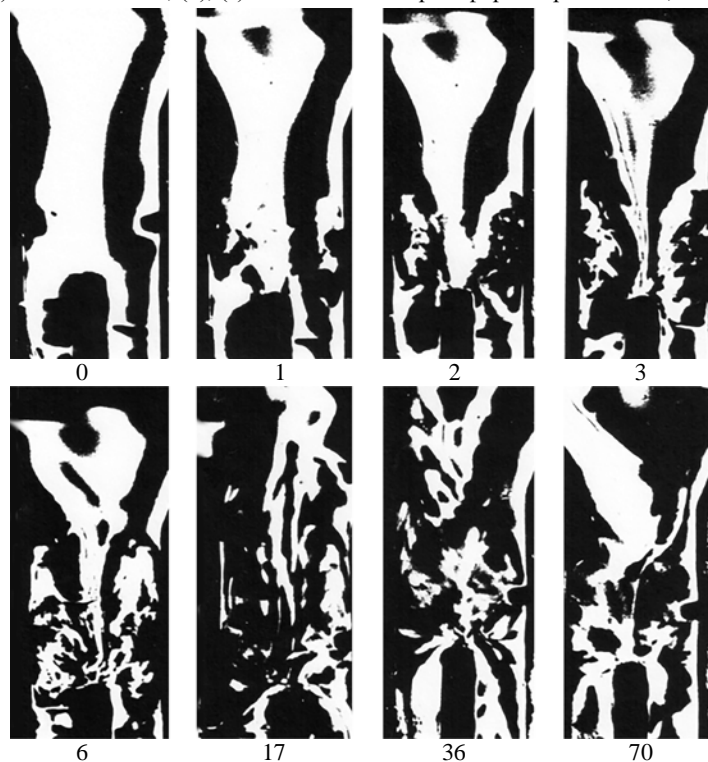
Рис. 14. Развитие ЭГД-течения при наличии изоляционного покрытия на эмиттере. Трансформаторное масло, U = -20 кВ, d = 2 мм, S_1 = 5 мм. 0, 1, 2, 3, 6, 17, 36, 70 – последовательность кадров. Скорость киносъемки 48 кадр/сек.
