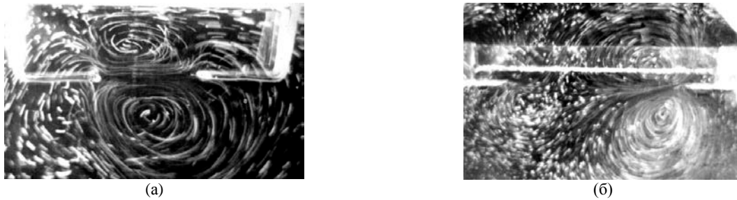
Рис. 1. ЭГД-течения в симметричных системах электродов в растворах трансформаторного масла с йодом [15]: (а) – система двух параллельных проволочек; (б) – система электродов лезвие–лезвие. Во всех случаях течение направлено от отрицательного электрода.
