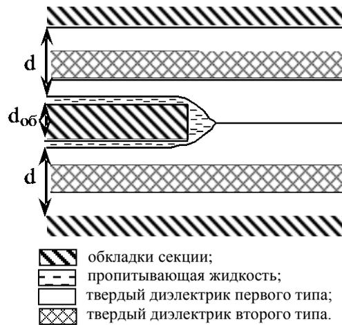
Рис. 1. Расположение слоев твердого диэлектрика и пропитывающей жидкости на краю обкладок секции конденсатора.
