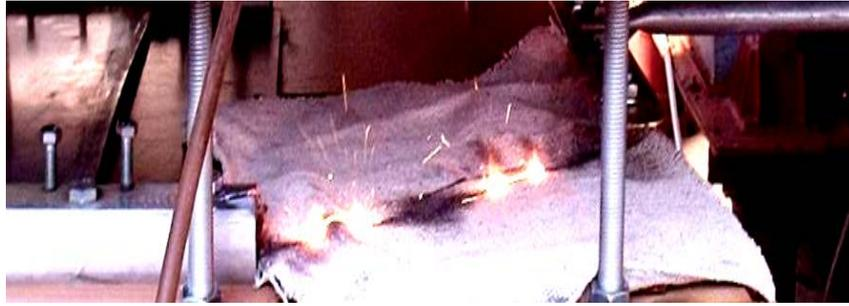
**Рис. 3.** Общий вид оцинкованного стального провода ( $r_0 = 0,8$  мм;  $l_0 = 320$  мм;  $\Delta_0 = 5$  мкм) после протекания по нему импульса аксиального электрического тока  $i_0(t)$  временной аperiодической формы 9 мс/160 мс большой плотности ( $I_{0m} \approx 745$  А;  $\delta_{0m} \approx 0,37$  кА/мм<sup>2</sup>;  $n_{0m} = 9$ ;  $\Delta z_{nh} \approx 7$  мм) [2].
