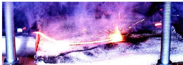
Рис. 1. Опытная демонстрация локального расплавления оцинкованного стального провода ( $r_0 = 0,8$  мм;  $l_0 = 320$  мм;  $\Delta_0 = 5$  мкм) разрядным импульсом аксиального тока  $i_0(t)$  временной формы 9 мс/160 мс от мощного ГИТ ( $\delta_{0m} \approx 0,37$  кА/мм<sup>2</sup>) в зоне его единственного ( $n = 1$ ) «горячего» продольного участка длиной  $\Delta z_{nh} \approx 7$  мм, остывающего на воздухе и огнестойком асбестовом полотне [8].
