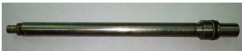
Рис. 3. Внешний вид волноводного пьезоэлектрического датчика импульсного давления типа ДТХ-1.
