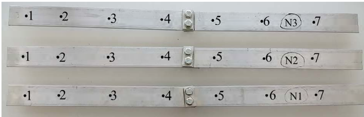
Рис. 4. Образцы: № 1 – без ингибитора; № 2 – с американским ингибитором; № 3 – с китайским ингибитором.
