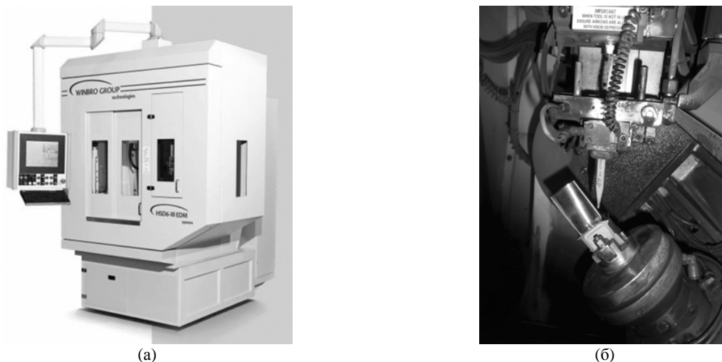
Рис. 6. Общий вид станка HSD6-III (а) и наладка станка на обработку отверстий в лопатке одиночным полым электродом (б).
