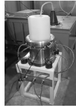
Рис. 1. Схема генератора и фотография камеры для электроимпульсного дробления.
