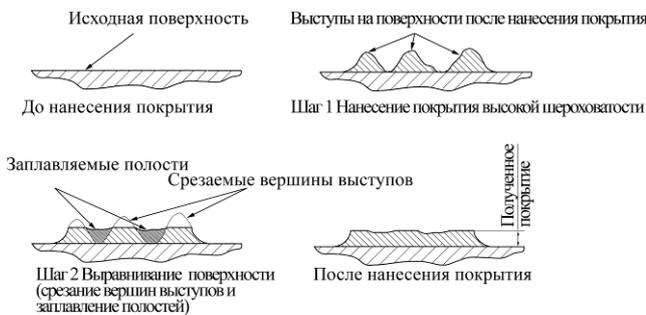
Рис. 2. Схема технологии получения покрытия повышенной толщины.
