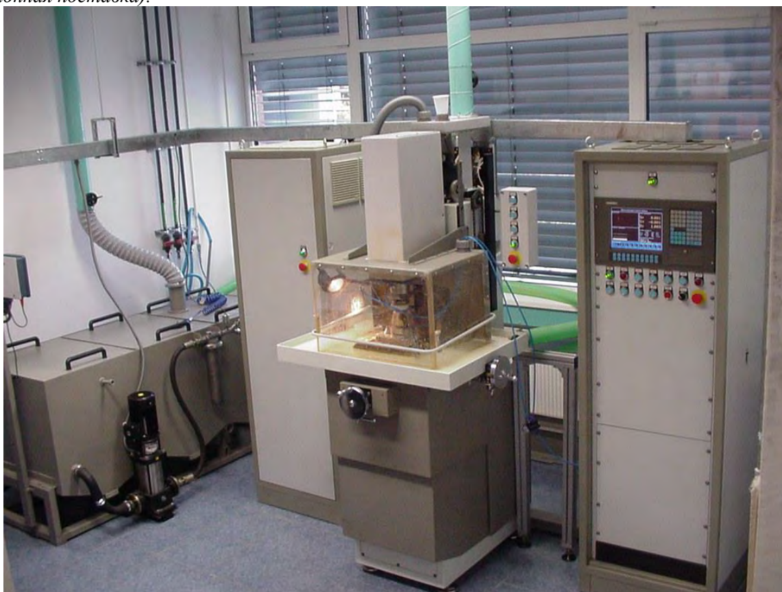
Рис. 4. Общий вид станка ЕСМ-1500А (слева направо расположены: гидроблок, генератор технологического тока, механическая система, стойка системы управления).
