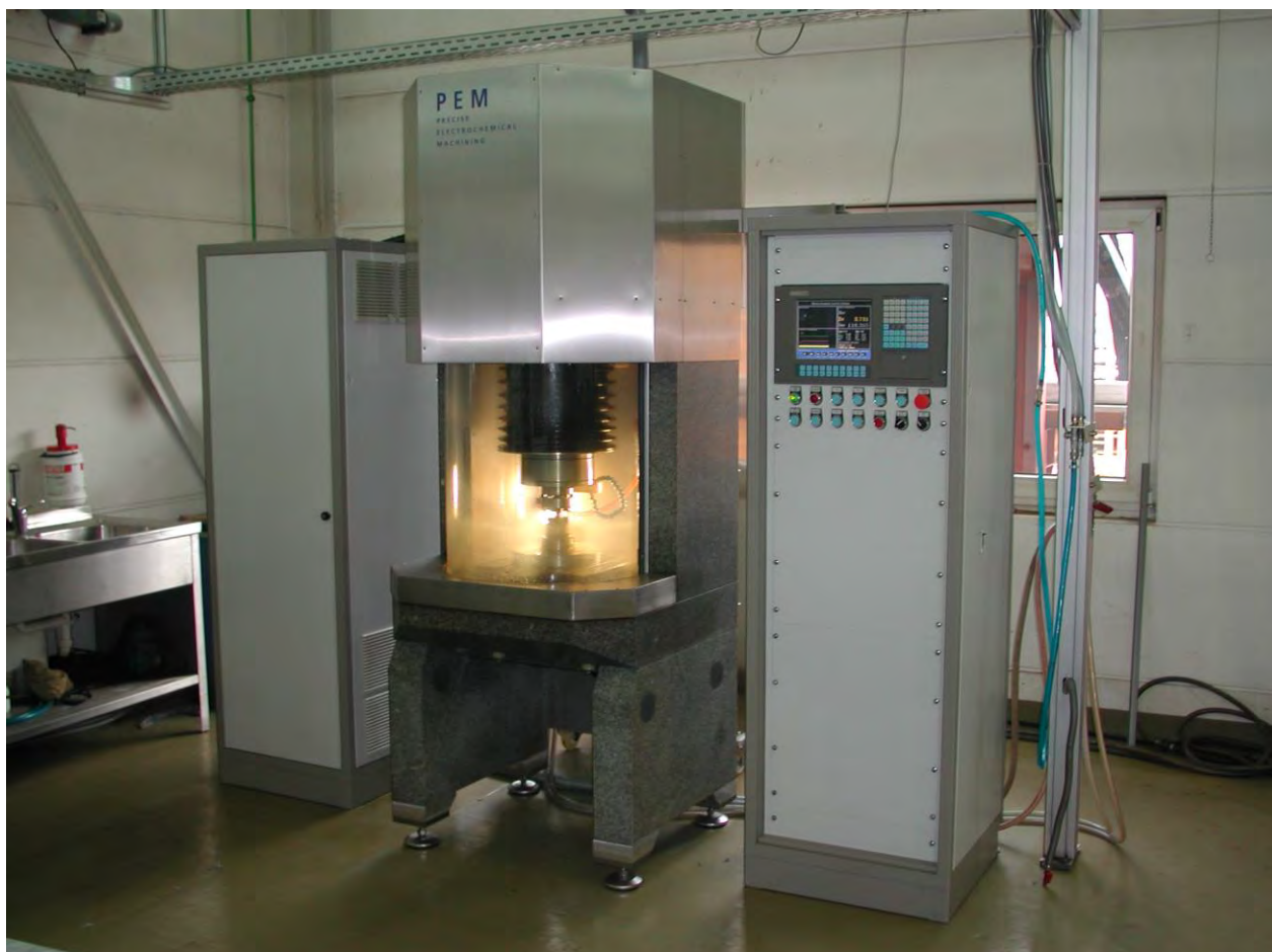
Рис. 5. Общий вид станка РЕМ-1360 (слева направо расположены: генератор технологического тока, механическая система, стойка системы управления).
