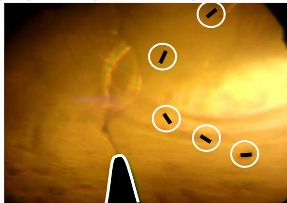
Рис. 8. Структуры течений при стальном электроде при 30 к/с.
