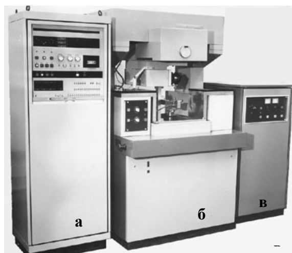
Рис. 9. Электроискровой комплекс «Электроника-04ИВ-250» модели А207.79: а – система ЧПУ 15ИПЧ-3-001 (И5М1.409.006); б – станочный модуль 04ИВ-250; в – генератор импульсный тиристорный А671.57.
