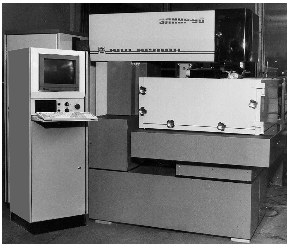
Рис. 12. Электроискровой комплекс "Элиур-90" (ЭХ 2214) с автоматической заправкой электрода-проволоки и управлением по 5 осям.
