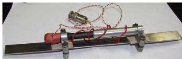
Рис. 3. Емкостной датчик деформации, закрепленный на плоском образце.
