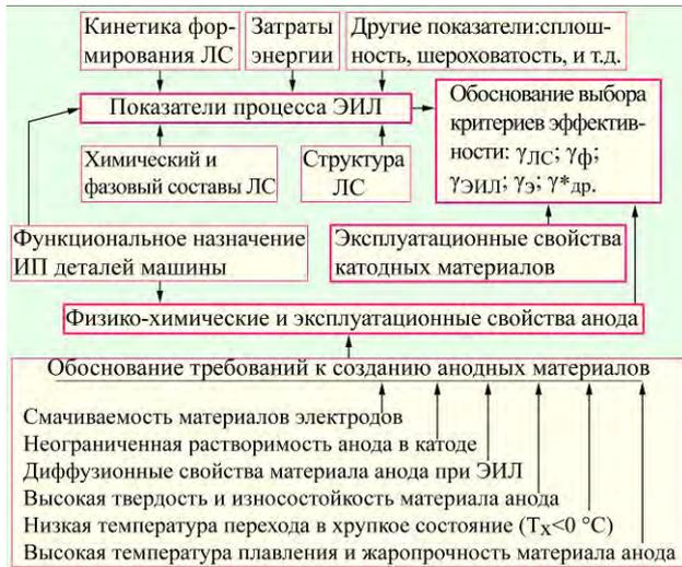
Рис. 3. Обоснование выбора критериев эффективности формирования ЛС на ИП деталей методом ЭИЛ.
