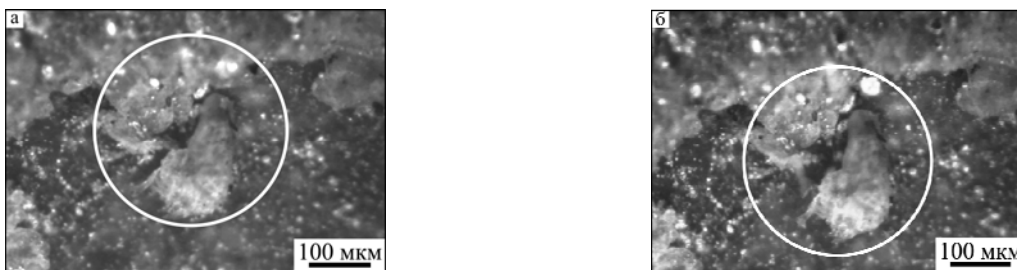
Рис. 3. Изменение взаимного расположения фрагментов структуры композиционного материала на основе политетрафторэтилена с металлическим наполнителем.
