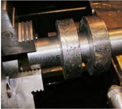
Рис. 1. БУФО стального образца после электроискровой цементации.
