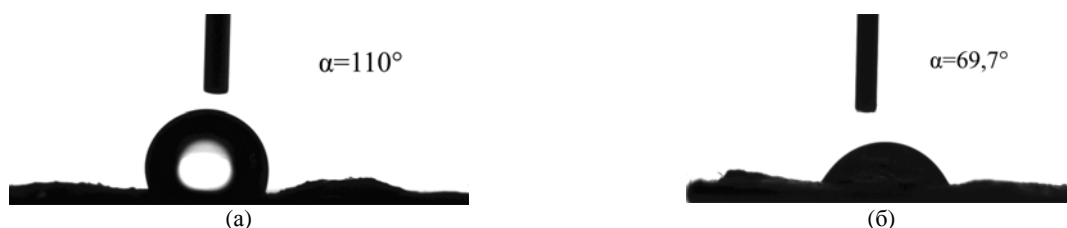
Рис. 3. Изображения краевого угла смачивания каплей дистиллированной воды с поверхности сорбционного материала: (а) исходный опад листьев березы; (б) опад, обработанный в коронном разряде (при U_{пол} = 30 кВ и t_{пол} = 45 с).
