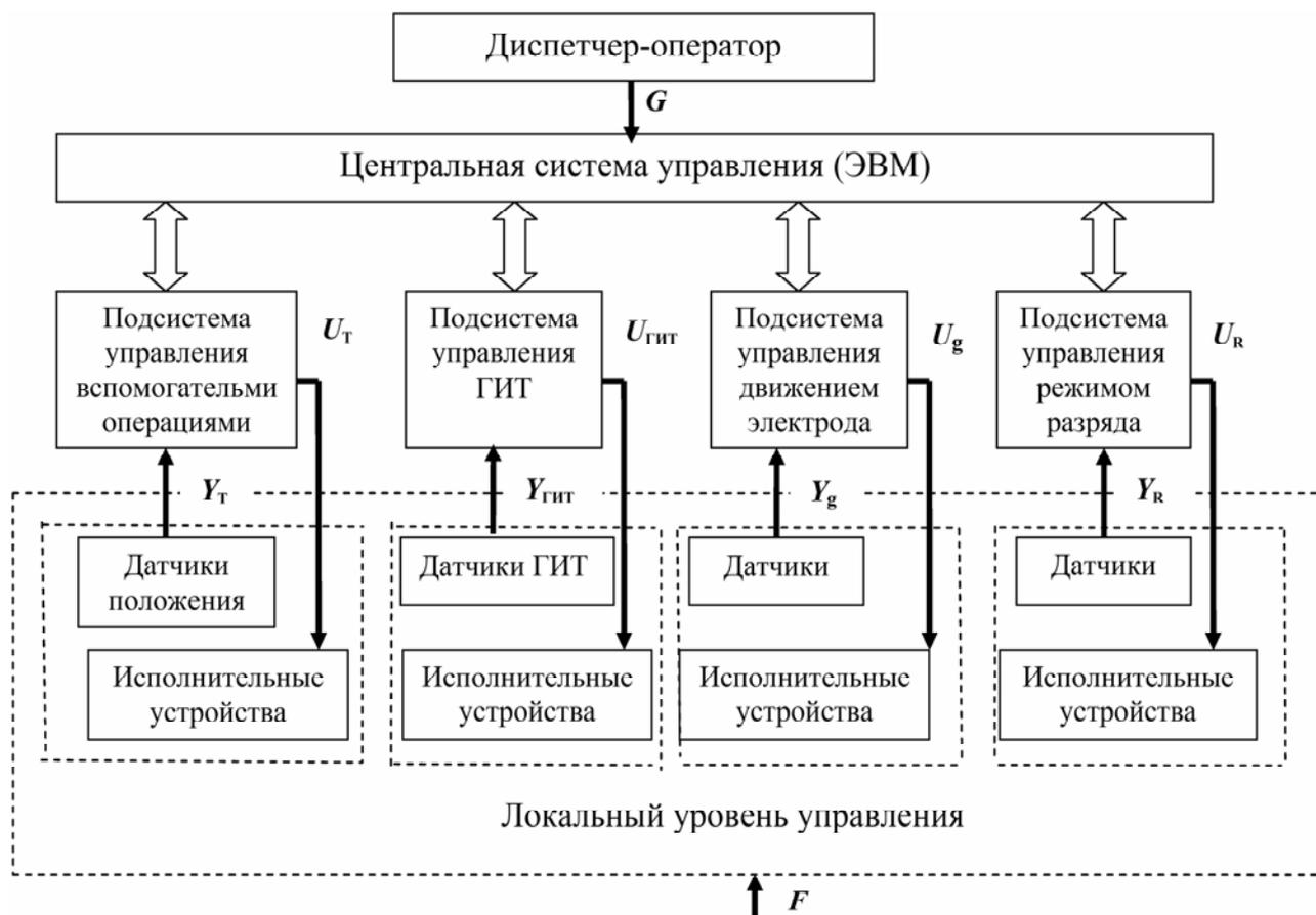
Рис. 1. Архитектура иерархической системы управления ЭГУ
