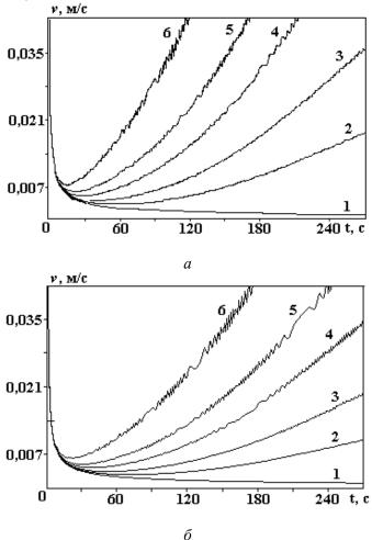
Результаты наблюдений за впитыванием воды в горизонтальные капиллярные трубки радиусами  $r = 5 \cdot 10^{-4} (a) \ u \ r = 5 \cdot 10^{-5} \ m (б). \ 1 - без поля и в НЭП: <math>2 - 5 \ \kappa B$ ;  $3 - 10 \ \kappa B$ ;  $4 - 17.5 \ \kappa B$ ;  $5 - 25 \ \kappa B$ ;  $6 - 40 \ \kappa B$  при T = 293 K
