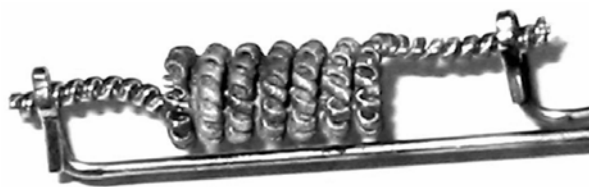
Рис. 2. Внешний вид оксидного электрода после ресурсных испытаний
