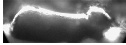
Рис. 2. Сталь 5XHM: электролит NaCl – 100 г/л,  $i = 4 \text{ А/см}^2$ ,  $\tau = 70 \text{ мин}$ .
