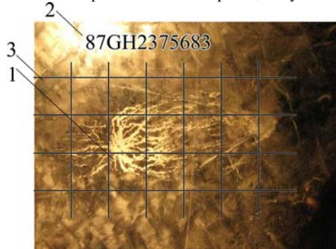
Рис. 9. Идентификационная метка от одиночного поверхностного разряда: 1 – матрица, полученная с помощью уникального поверхностного разряда; 2 – буквенно-цифровой код; 3 – информационная сетка. Размер пятна – 5–7 мм.
