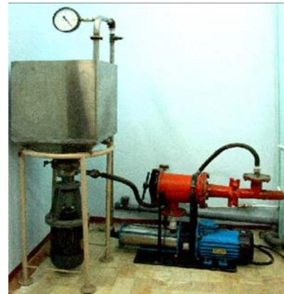
**Рис. 9.** Технологическая бичастотная кавитационная линия для тонкого диспергирования бентонита.
