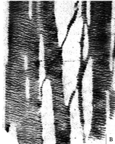
Рис. 7. Электронно-микроскопический снимок неориентированных образцов ПВДФ, обладающих сферолитной структурой (а); изменение структуры при одноосном деформировании исходных образцов \epsilon , %: (б) – 60, (в) – 400.
