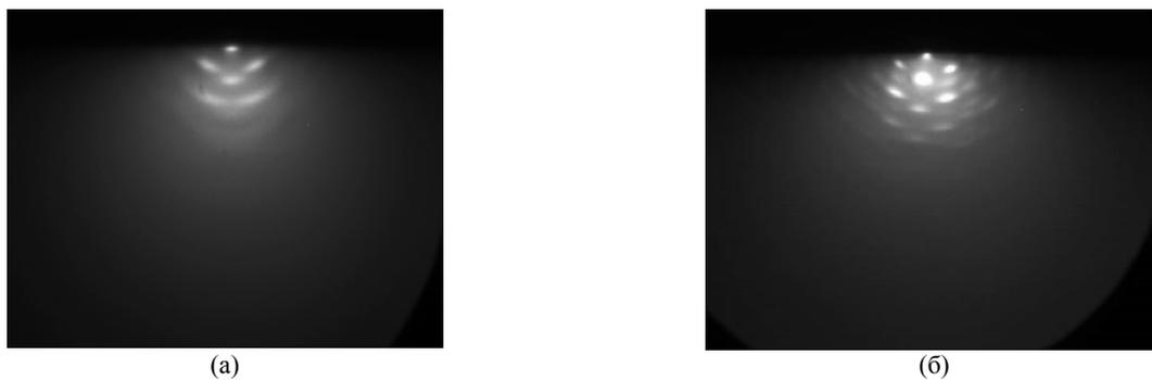
Рис. 4. Дифрактограммы нанокристаллических пленок ZnO при соотношении  $i/A = 0$  (а) и  $i/A = 0,75$  (б).
