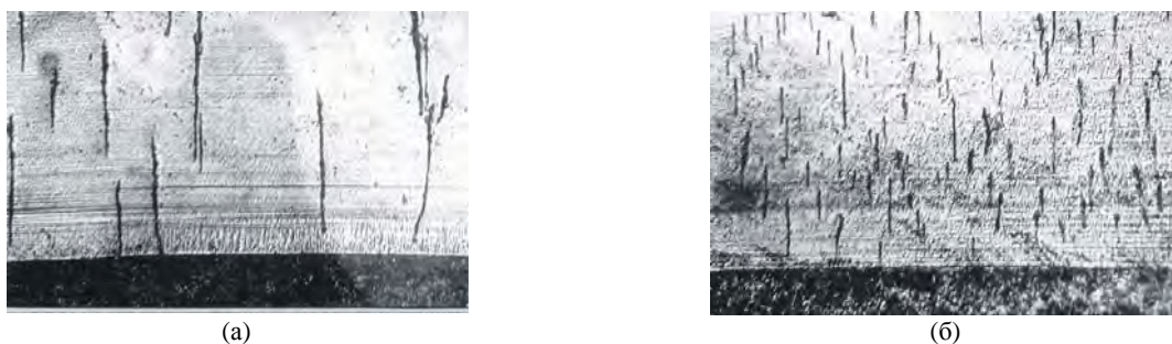
Рис. 2. Структура электролитического железа при «мягком» (а) и «жестком» (б) режимах электролиза.
